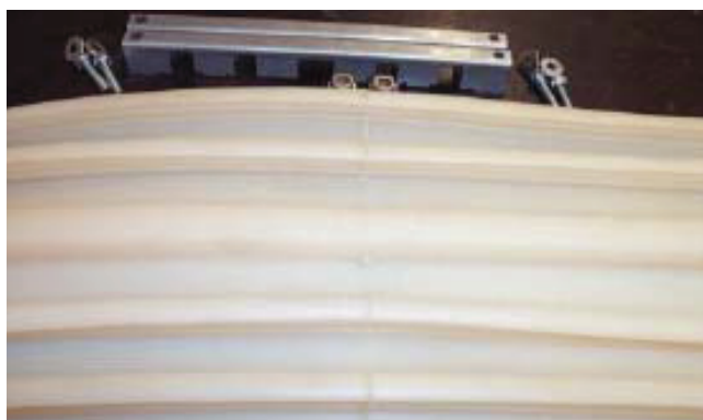
V. Schweißmatrize entfernen, abkühlen lassen und prüfen, ob Verschweißung ordnungsgemäß erfolgt ist. Falls nicht, muß die Verschweißung gem. den Punkten I-IV wiederholt werden. Release jig, allow to cool and inspect welded joint for continuity of weld and correct alignment of profiles. If the weld is unacceptable repeat operations I-IV.
